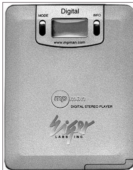
Abbildung 4.3: 1998 erschien der erste tragbare MP3-Player, der „mpman“ von SaeHan mit unglaublichen 32 MByte Flashspeicher
